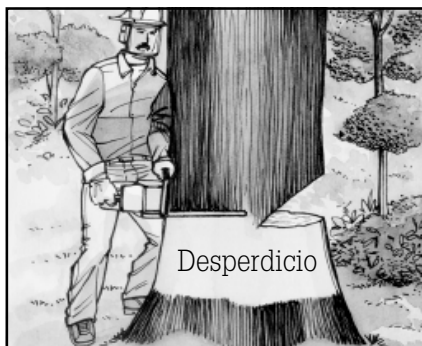
• Figura 11. Error en la altura del corte
