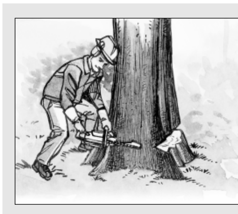
• Figura 12. Posición correcta para el corte de abatimiento.
