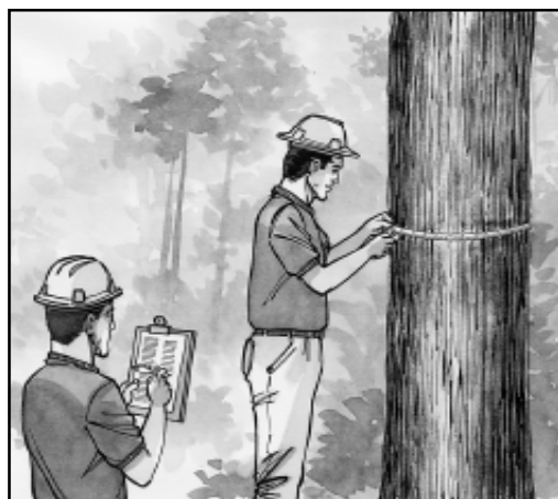
a. Medición a altura del pecho
