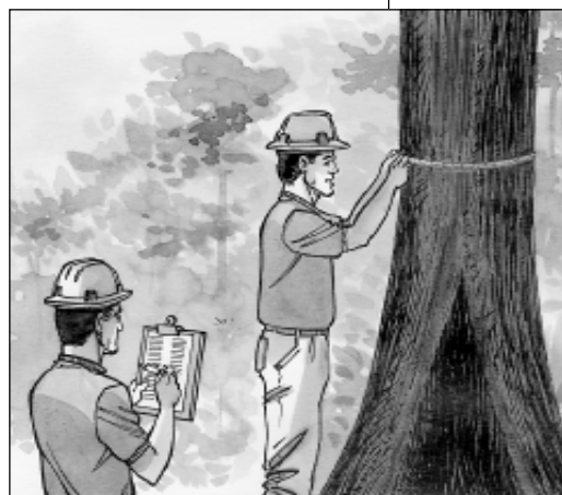
b. Medición arriba de las raíces tubulares
